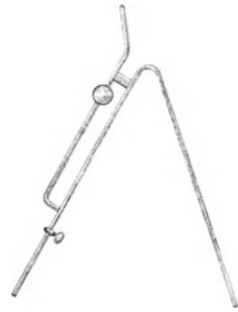
Fig. 5. Heber mit seitlich angesetztem Saugrohr.
