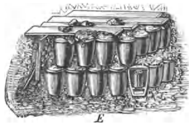
Fig. 367. Bleiweiß-Fabrikation nach holländischer Methode.
