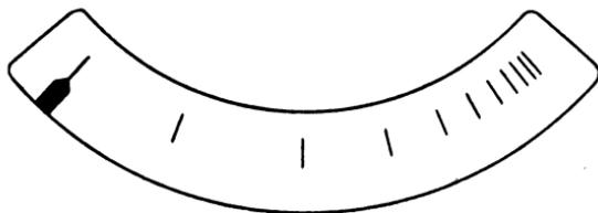
Bild 38. Skalenteilung eines Nullspannungsmessers mit Dreheisen-Meßwerk und Vorschaltlampe. Durch den veränderlichen Vorwiderstand sind die Skalenteile am Anfang sehr weit auseinandergezogen, so daß eine besonders große Anfangsempfindlichkeit des Instrumentes erreicht ist. Der Wert eines Skalenteiles ist ein Zehntel des Skalendendwertes.
