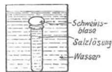
Abb. 262. Wirkung des osmotischen Druckes.
