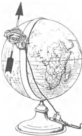
Abb. 126. Zum Kreiselkompaß. Die Figurenachse des rotierenden Kreisels auf dem Meridian stellt sich infolge der Achsendrehung der Erde in die Ebene des Meridians.
