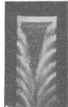
Abb. 569. Elektrischer Funke, im rapide rotierenden Spiegel gesehen. (Zu beachten: Einer hellen Stelle am linken Rande liegt gegenüber eine dunkle am rechten und vice versa.)
