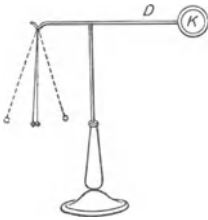
Abb. 412. Zwei pendelartig aufgehängte Körper zeigen durch ihre gegenseitige Abstoßung Ladung der Körper an.
