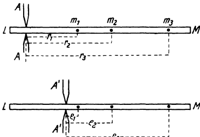
Abb. 112. Dieselben Massenpunkte m stehen von der einen Achse um r , von der anderen um \rho ab.
