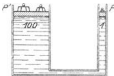
Abb. 174. Prinzip der hydraulischen Presse.
