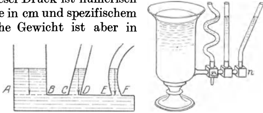
Abb. 183. Flüssigkeiten vom selben spezifischen Gewicht stehen gleich hoch in kommunizierenden Gefäßen.
