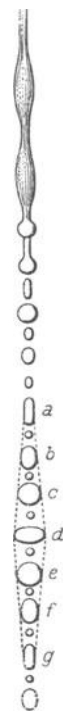
Abb. 237. Der Anblick eines Flüssigkeitsstrahles (Knoten u. Bäuche) und seine wahre Beschaffenheit (Tropfen, die periodisch ihre Form ändern; a bis g Phasen der Form).
