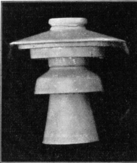
Abb. 62b. Erste Büschelentladungen unter Regen.
