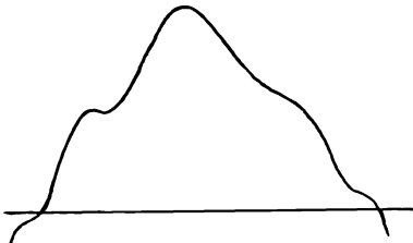
Abb. 126. Spannungswelle bei 19 A. 20 Isolatoren am Transformator bei 100 000 V. \sigma = 1,58 .
