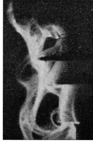
Abb. 43. Lichtbogen unter Regen bei 65000 V.
