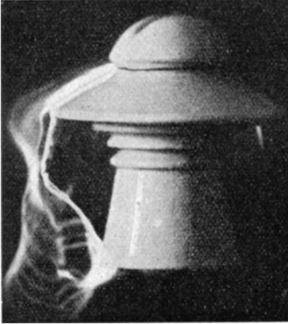
Abb. 42. Lichtbogen unter Regen bei 58000 V.
