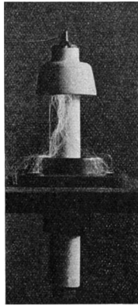
Abb. 106. Gleitende Entladungen, die von einem Dach abgefangen werden.
