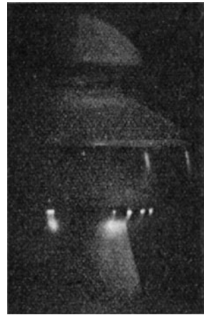
Abb. 46. Vom Zwischenmantel ausgehende Büschelentladungen.
