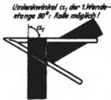
Abb. 684. Ablenkung wie in Abb. 683. 1. Wendestange senkrecht zur Bandanlaufichtung.
