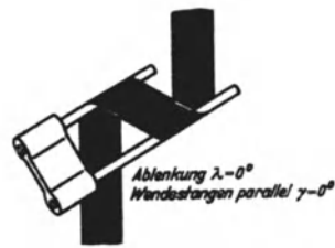
Abb. 686. Ablenkung um 0°, jedoch seitliches Verlagern des Bandes.
