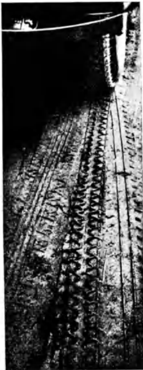
Abb. 339. Kraftwagenrad mit in der Fahrbahn erzeugter Zahnstange. (Längszahn zur Führung der Lenkräder, Quersahn zur Stützung der Treibräder. Gerade erzeugte Spur aus beiden zusammengesetzt.
