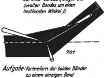
Abb. 700—703. Einfalten eines Saumes. Biegewinkel \beta nicht vergessen!
