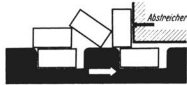
Abb. 469. Werkstücklager in voller Tiefe der Werkstückhöhe würden nicht zu Sperrungen führen, wie in Abb. 468.
