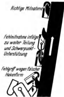
Abb. 479. Vorrichtung, wie in Abb. 472 u. 473 mit Häkchen (vgl. Abb. 398) für Kappen von Sicherheitsnadeln (Fehlmitnahmen).
