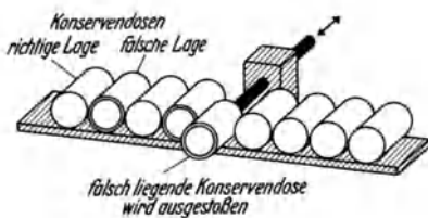
Abb. 522. Nachordnen von Konservendosen mit Stoßkupplung.
