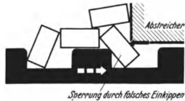
Abb. 470. Bei falschem Einkippen der Werkstücke sperrt aber auch eine Magazinierung wie in Abb. 469.
