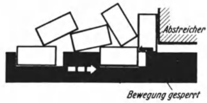
Abb. 468. Vorrichtung nach Abb. 465 u. 466, jedoch für kantige Werkstücke gibt Sperrung zwischen mitgenommenen und zurückbleibenden Werkstücken.
