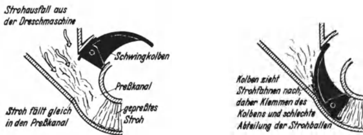
Abb. 498. Läßt man den Strohgriener (Abb. 497) weg, so fehlt die Magazinierung. Das Pressen wird durch nachgezogene Strohschwänze erschwert, die einzelnen Strohballen hängen zusammen und lassen sich daher schlecht einzeln abnehmen.
