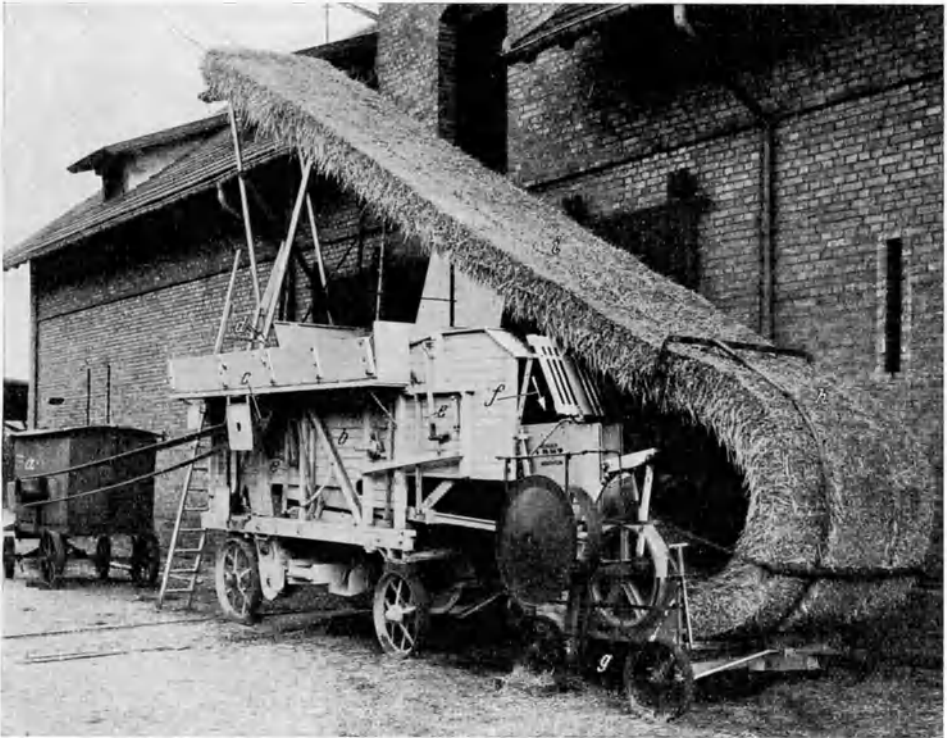
Abb. 669. Stohrückeitung an einer Strohpresse. Umleitung erfolgt durch eine Stoßführung (vgl. Abb. 663). a Antrieb, b Dreschmaschine, c Welle der Dreschmaschine, d Garbeneinwurf, e Blattfeder (Holz) als Lenker für die Führung des Strohschüttlers, f Strohausfall aus der Dreschmaschine in die Presse, g Strohpresse, h Stohrückeitung, i gepreßtes Stroh.
