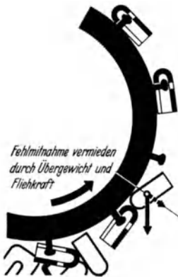
Abb. 481. Anordnung von Pilzchen wie in Abb. 480 außen an einer Trommel (ohne Fehlmitnahme).
