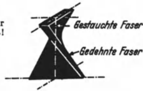
Abb. 677. Schraubenfläche zur reinen Führung ungeeignet!
