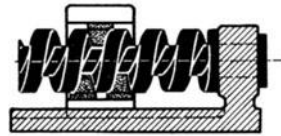
Abb. 24. Schraubentrieb mit Rollenordnung. Wiedereinführen des 4. Gliedes.
