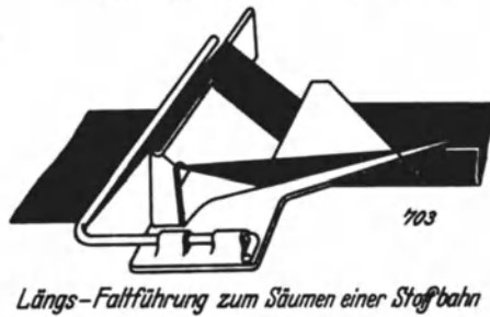
Abb. 700—703. Einfalten eines Saumes. Biegewinkel \beta nicht vergessen!
