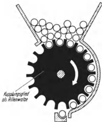
Abb. 467. Kuppelnde Magaziniervorrichtung nach Abb. 464—466 jedoch mit trommelartig ausgebildetem drehendem Kuppelungsglied.
