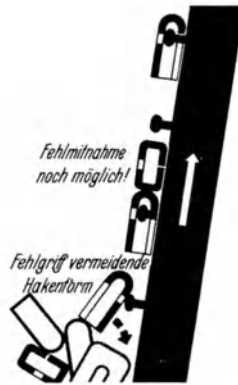
Abb. 480. Vorrichtung, wie in Abb. 479, jedoch mit Pilzchen statt Häkchen (weniger Fehlmitnahmen).
