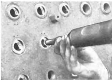
Abb. 56 Durchschlagen mit FMA-Meißelhammer Tabelle 23 Nr. 1—24
