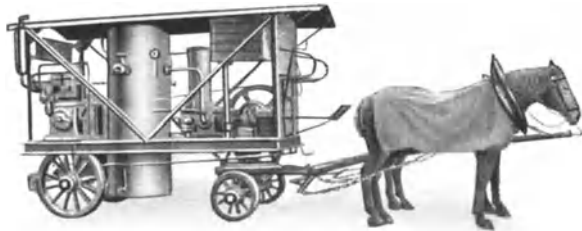
Abb. 147 Älterer fahrbarer Druckluffterzeuger mit liegendem Kompressor Bauart SR
