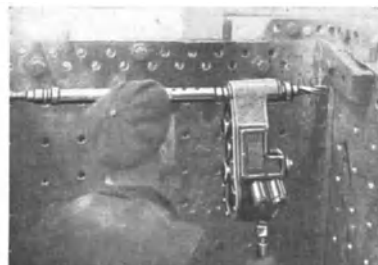
Abb. 65 Bohren mit FMA-Eckenbohrmaschinen Tabelle 26 Nr. 21 / 22 / 41—44
