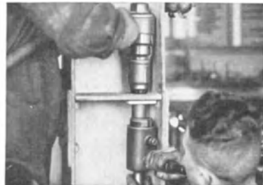
Abb. 45 Spantennieten mit FMA-Eck-Niethammer Tabelle 22 Nr. 17, 51—55
