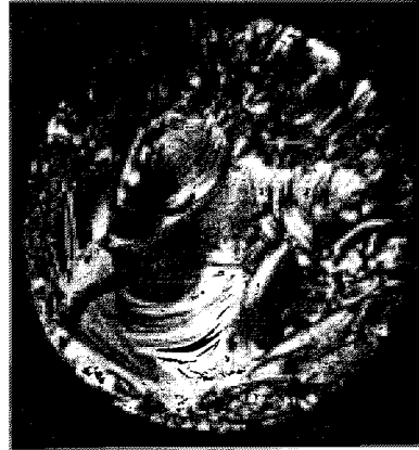
Abb. 20. Muschelige Zerreißfläche eines in Raumtemperatur zerrissenen Glasstäbchens (40fache Vergrößerung). (G. APFELT.)
