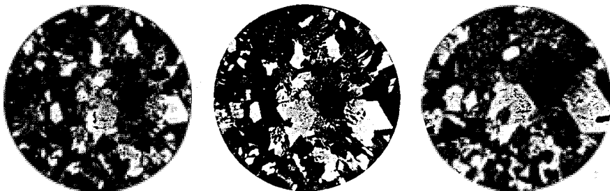
Abb. 33. Eisenauskristallisation im Elektronenmikroskop beobachtet ( V = 60 ). [BRÜCHE und KNECHT (29)]
