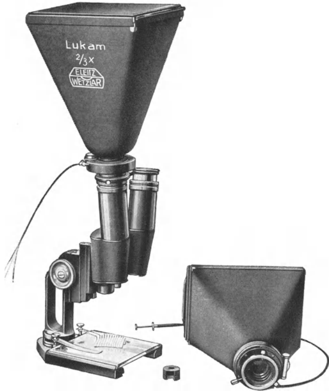
Abb. 161. Die Aufsatzkamera „Lukam“ mit einem binokularen Präpariermikroskop der Firma E. LEITZ. (Aus LEITZ-Druckschrift: Mikrophoto 2329.)
