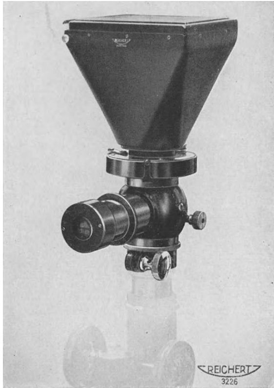
Abb. 80. Aufsatzkammer der Firma C. REICHERT. Neue Ausführung mit einer kleinen Kamera.
