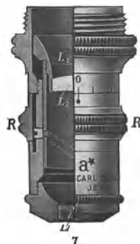
Abb. 10. Schwaches Objektiv (ZEISS Obj. a*) mit veränderlicher Vergrößerung.
