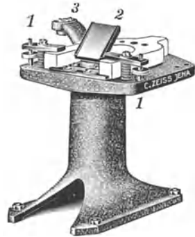
Abb. 63. Hohe Fußplatte mit Spiegel. (Aus ZEISS-Druckschrift: Mikro 401.)
