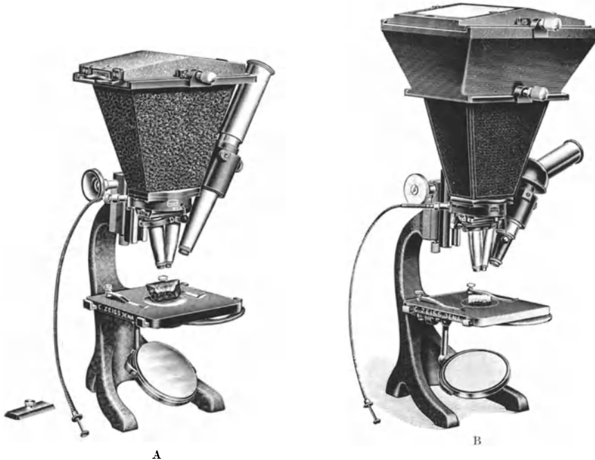
Abb. 159. Stereoskopkamera nach DRÜNER mit (B) und ohne (A) Vergrößerungsaufsatz. (Aus ZEISS-Druckschrift: Mikro 257.)
