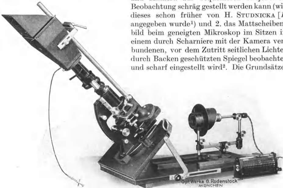
Abb. 84. Der SKELLSche mikrophotographische Apparat in Winkelstellung. (Aus HEIM u. SKELL [1. Abb. 19, S. 47].)
