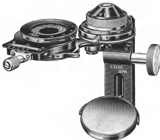
Abb. 17. ABBEScher Beleuchtungsapparat mit ausgeklapptem dreh- und verschiebbarem Blendenträger. (Aus A. KÖHLER [9, Abb. 230, S. 287].)
