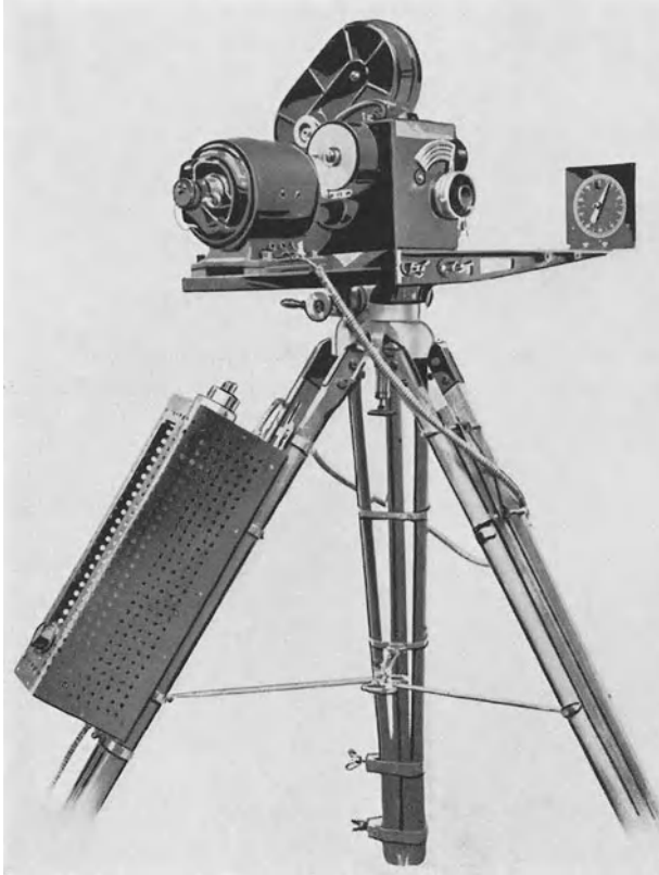
Abb. 233. Hochfrequenzberufskamera („Grande vitesse DEBRIE“) in waagerechter Stellung mit elektrischer Uhr zur Zeitmarkierung. (Aus K. HÖFER [1, Abb. 132, S. 465].)
