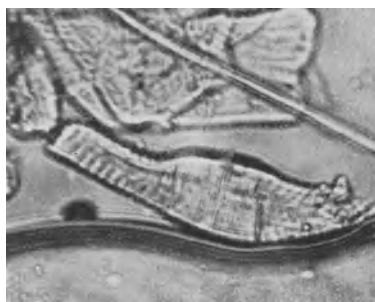
Abb. 188. Dieselbe Faser bei nicht gekreuzten Nikols. Linsenfolge, Kammerlänge und Bildvergrößerung wie bei Abb. 187. Bogenlicht. Belichtung: 4 Sek.
