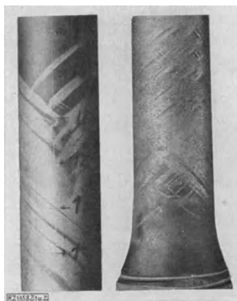
Abb. 1 und 2. Fließfiguren an einem Zugstab aus Siliziumstahl (Vorder- und Rückseite).
