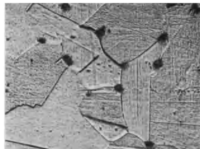
Abb. 36. Cu-Zn-Pb-Legierung mit 61,14% Cu, 2,25% Pb. Bei 870^\circ abgeschreckt und darauf 24 St. bei 425^\circ angelassen. v = 400 .
