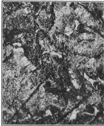
Abb. 58. I. Glühstufe bei 450°. Nr. 40. v = 200 .
