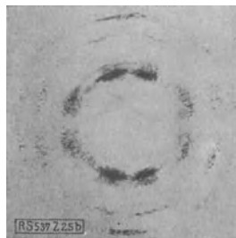
Abb. 25 b. Rekristallisationstextur ( 700^{\circ} ). [112] parallel zur Walzrichtung, (131) parallel zur Walzebene.
