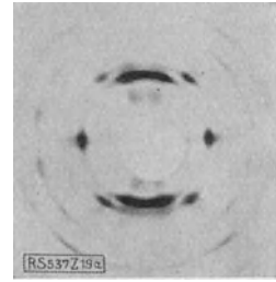
Abb. 19a. Aluminium. 1. [112] parallel zur Walzrichtung, (110) parallel zur Walzebene. 2. [111] parallel zur Walzrichtung, (110) parallel zur Walzebene.
