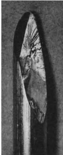
Abb. 1. Reißstelle eines Tellurkristalls (nach E. Sch. und G. Wassermann).
