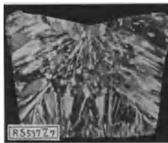
Abb. 7. Schnitt eines Aluminiumbarrens (nach J. Czoehralski) rd. \frac{1}{4} nat. Gr.
