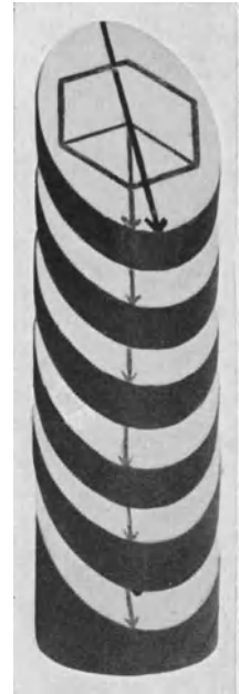
Abb. 2. Schema der Translation (nach H. Mark, M. Polanyi und E. Sch.). a) Zylindrischer Ausgangskristall mit freigelegter Translationsfläche. Der parallel einer Seitenkante des aufgedruckten Sechsecks verlaufende Pfeil stellt die Translationsrichtung dar. b) Seitenansicht, c) Vorderansicht des gedehnten Modelles.
