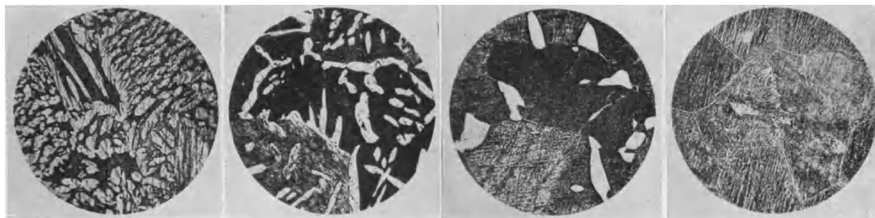
Anlieferungszustand (langsam erkaltet?) von 650° abgeschreckt von 700° abgeschreckt von 750° abgeschreckt
