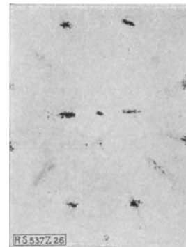
Abb. 26. Rekristallisationstextur von Kupferblech (nach R. Glocker und H. Widmann). [100] parallel zur Walzrichtung, (001) parallel zur Walzebene.
