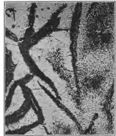
Abb. 59. II. Glühstufe bei 650°. Nr. 40. Rand. v = 200 .
