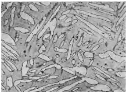
Abb. 43. Cu-Zn-Pb-Legierung mit 61,08% Cu, 1,99% Pb. 2 St. bei 800° gegläht und abgeschreckt. v = 100 .
