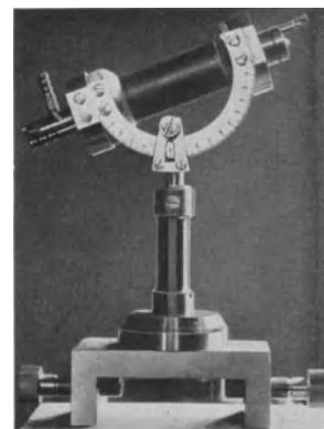
Abb. 11. Ansicht eines Ofens für Laue-Aufnahmen (1/4 natürliche Größe).
