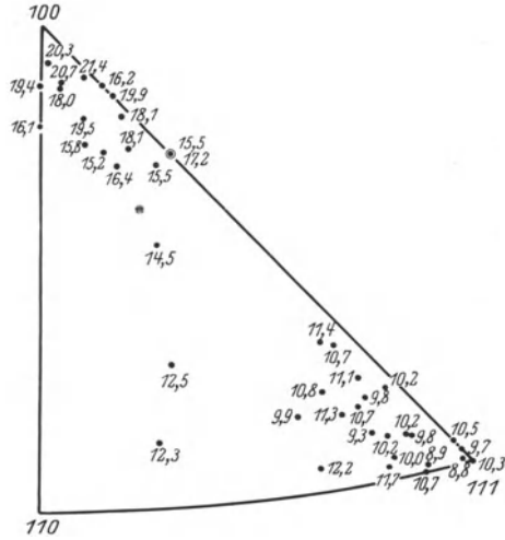
Abb. 4. Torsions-Streckgrenze von Kristallen einer Aluminiumlegierung. (in \text{kg}/\text{mm}^2 )
