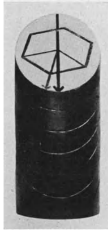
Abb. 2. Schema der Translation (nach H. Mark, M. Polanyi und E. Sch.). a) Zylindrischer Ausgangskristall mit freigelegter Translationsfläche. Der parallel einer Seitenkante des aufgedruckten Sechsecks verlaufende Pfeil stellt die Translationsrichtung dar. b) Seitenansicht, c) Vorderansicht des gedehnten Modelles.
