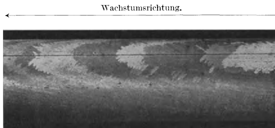
Abb. 5. Messingkristall (72% Cu) mit Wachstumsfehler, 2,3 fach vergrößert. Geätzt mit verdünntem Königswasser.
