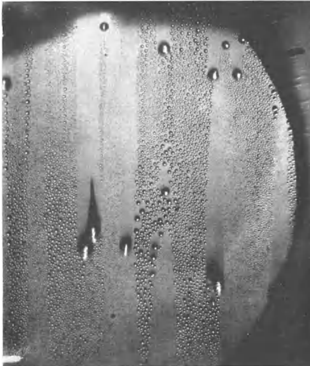
Abb. 181. Tropfenkondensation an einer polierten und verchromten Kupferplatte (der rechts sichtbare Rand der kreisförmigen Platte hat einen Dmr. von 15 cm).
