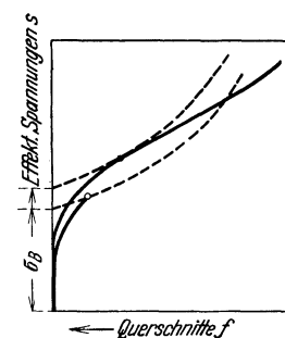
Abb. 17. Schematische Darstellung zur Kontrolle der Erfüllung der Höchstlastbedingung beim Zugversuch.
