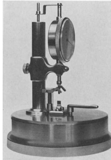
Abb. 55. Meßtisch zum Ausmessen des Kernquerschnitts. D. R. P. und D.R.G.M. angemeldet.
