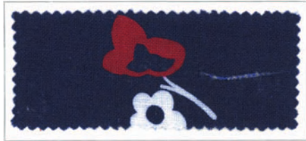
8. Reservedruck auf Baumwolle: Weissreserve und Rotreserve mit Echtrotsalz KB unter Variaminblau B/Naphtol AS-Färbung
