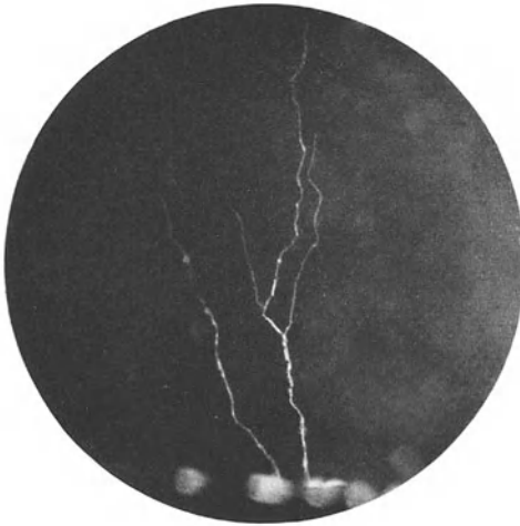
Abb. 99. Entladungskanäle in einer Glasplatte, Schichtdicke 5,5 mm; gestoßen bei 72 kV während 0,15 \mu s unter Öl. (Seitenansicht, 35fache Vergrößerung.)
