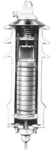
Abb. 217. Ableiter mit spannungsabhängigem Widerstand. Oben: Löschfunkenstrecke; unten: spannungsabhängige Widerstände.
