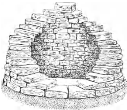
Abb. 89. Ofenschacht aus sorgfältig behauenen Quarzschiefersteinen.
