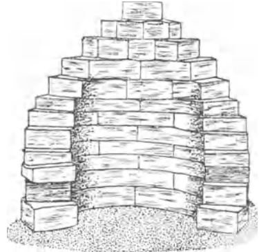
Abb. 90. Ofenschacht aus gesägten Quarzschiefersteinen.
