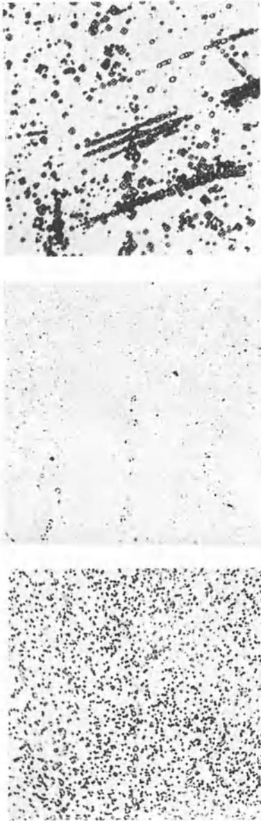
Gefügeentwicklung einer Schlifprobe aus 16proz. Chromstahl (0,08% C, 0,4% Si), dargestellt durch Abbildungen der gleichen Probenstelle nach mehrfachem Ätzen mit verschiedenen Ätzmitteln und jedesmaligem Zwischenschleifen. (Vergr.  $\times 500$ .)
