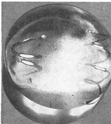
Abb. 2. Einbettung von zwei Widerstandsdrähten aus Chrom-Nickel-Legierung, längs und quer angeschliffen, ungeätzt, durchsichtige Weichpreßmasse. (Vergr.  $\times 2$ .)
