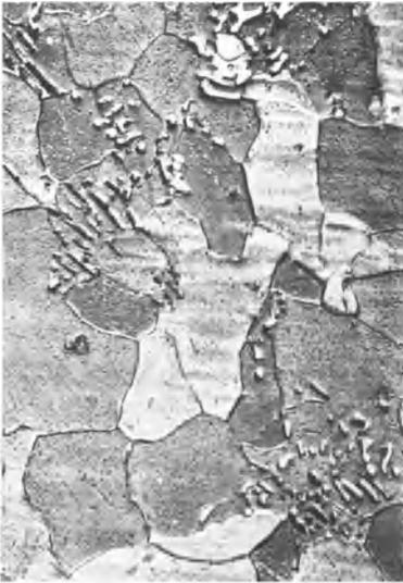
Abb. 19a. Tempergußprobe mit Resten von Zementit. Ätzung: alkoholische Salpetersäure mit darauffolgendem Anlassen. Der Zementit hebt sich hell von der auf gelbbraun angelassenen ferritischen Grundmasse mit verschieden getönten Kristalliten ab. Schräg von oben beleuchtet, vgl. Schattenlage der Zementitnadeln, Beispiel für Feststellung des Lichteinfalls bei Schrägbeleuchtung (hierzu S. 3).
