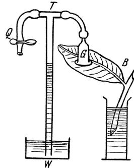
Abb. 21. Porometer. Erklärung im Text. (Nach F. DARWIN.)
