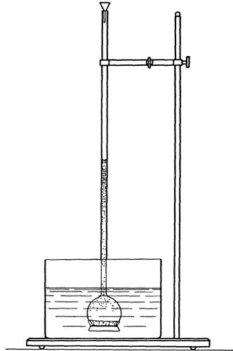
Abb. 2. Osmometer von DUTROCHET.
