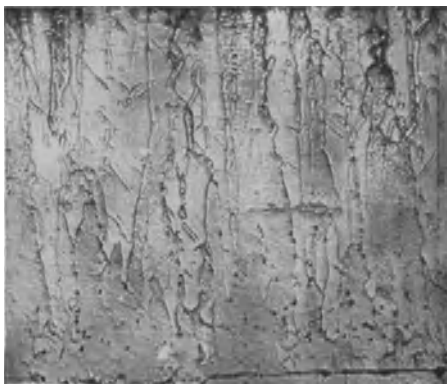
Abb. 52. 900fach. 6 einzeln aufeinander niederschlagene Schichten, jedesmal dazwischen der Luft ausgesetzt, vor Wiederaufnahme der Elektrolyse mit 65%iger H_2SO_4 behandelt. Trennungslinien waren nicht sichtbar und erschienen auch auf diesem Bilde nach halbstündiger Erhitzung auf 900^\circ nicht (vgl. hingegen hierzu Abb. 75—77, S. 205 ff.).
