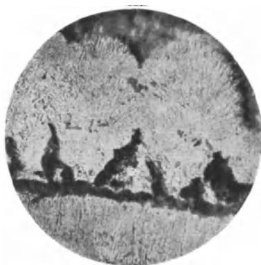
Abb. 33. Mikroaufnahme einer mit zu hoher Stromdichte auf gutem Elektrolyt-Kupfer hergestellten Cu-Niederschläge. 1
