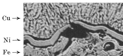
Abb. 54. 1000fach. 1 Ungenügend gereinigte Eisenoberfläche; der Ni-Niederschlag überbrückt diese Stelle, ohne am Fe aufzusitzen, der darauf folgende Cu-Niederschlag schließt die Brücke vollends, ohne das Haften verbessern zu können.
