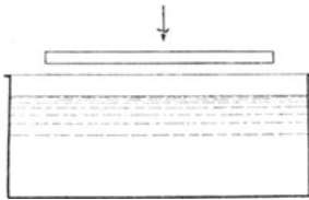
Fig. 111. Falsches Eintauchen des Werkstückes in die Abkühlflüssigkeit.
