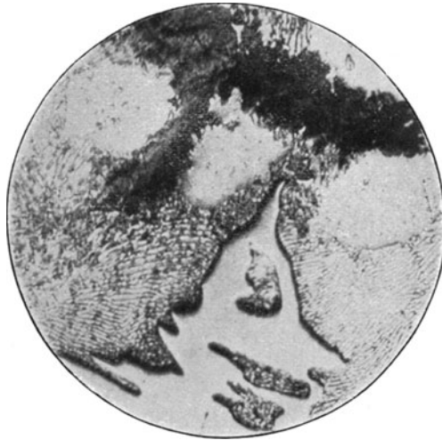
Fig. 2. Der glatte weiße erhabene Teil ist Eisenkarbid (sog. Cementit), der glatte vertiefte weiße Teil ist kohlenstoffreies Eisen (Ferrit), der schwarze ist Temperkohle. Vergrößerung = 500. (Aus Wawrziniok, Materialprüfung.)
