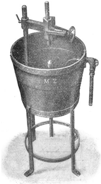
Fig. 117. Wasserstrahlvorrichtung zum Härten von Döppern.
