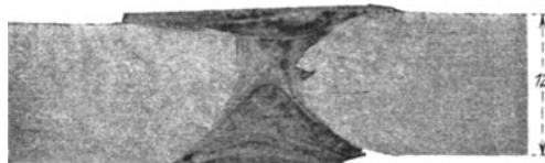
Fig. 52. Autogen geschweißtes Flußeisenblech.
