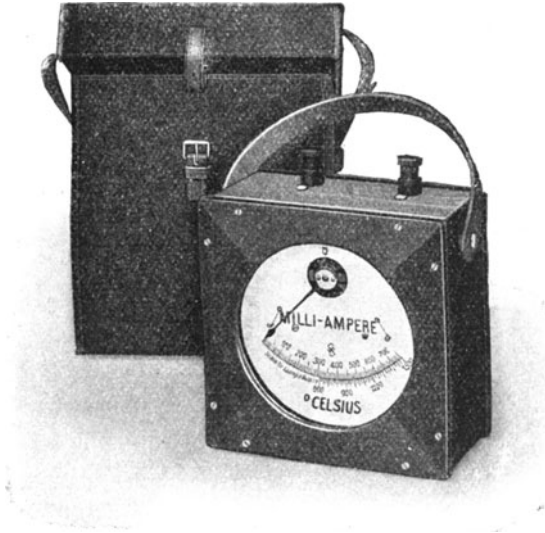
Fig. 108. Tragbarer Strommesser zum optischen Pyrometer.
