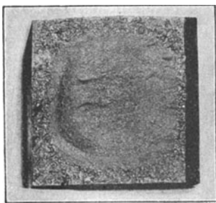
Fig. 25. Grobkörniger Bruch an Kanten und Ecken eines eingesetzten Stahles. (Aus Brearley-Schäfer, Werkzeugstahl.)
