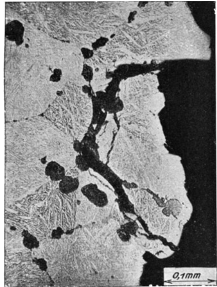
Fig. 163. Gefüge an Rand und Mitte des in Fig. 170 abgebildeten verbrannten Stückes der Härteschlange. (Aus Bach-Baumann, Gefügebilder.) Vergrößerung = 150.
