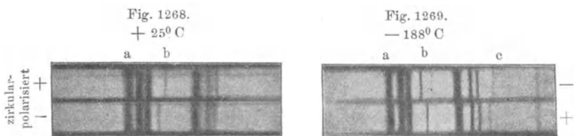
Longitudinaler Zeemaneffekt an einer Bandengruppe des Xenotims im Grünen nach J. Becquerel. Kristallplatte 0,8 mm dick; Magnetfeld 12 000 Gauß.
