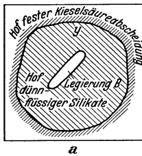
Abb. 129. Wirkungsweise der Desoxydationslegierungen B und C in Abb. 127 b (Körber und Oelsen).
