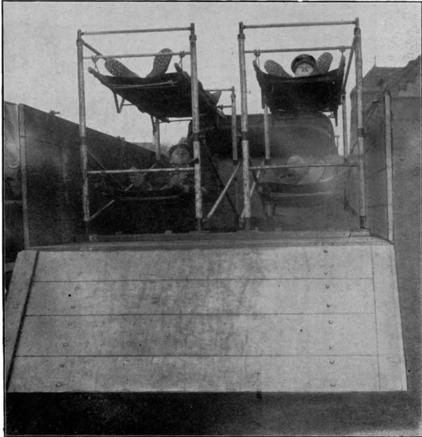
Bild 61. Lagerung in Linxweilerscher Vorrichtung.
