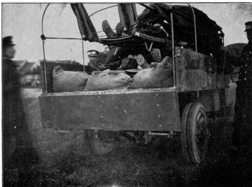
Bild 75. Leichter Lastkraftwagen, obere Trage in Gummischläuchen, untere Tragen auf Sandsäcken.
