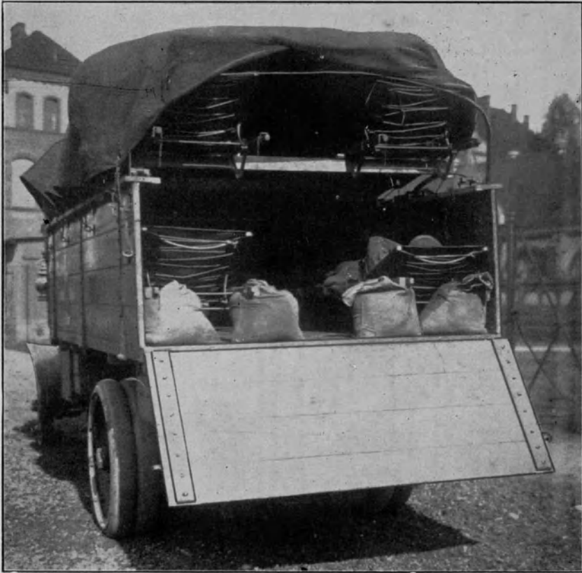
Bild 57. Lagerung auf Grundschen Blattfedern und Sandsäcken mit Verdeck.
