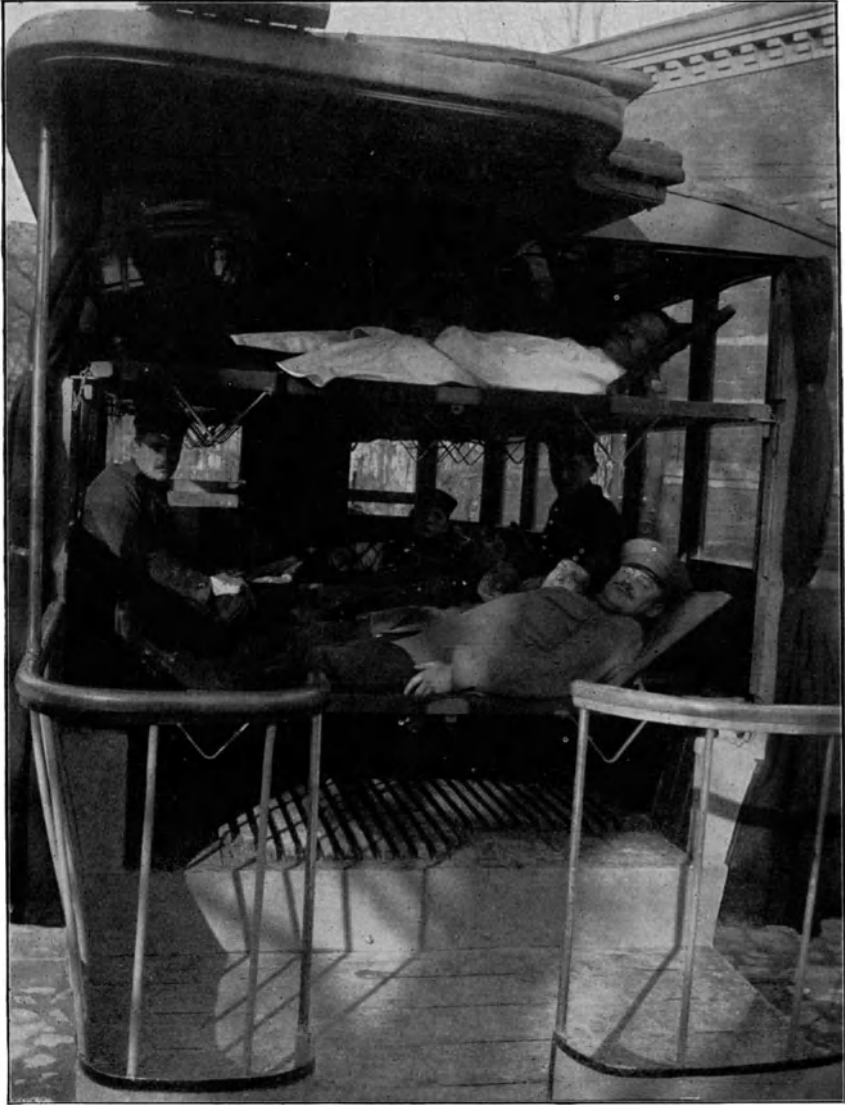
Bild 78. Omnibus der Berliner Allgemeinen Omnibus-Aktien-Gesellschaft, Querlagerung nach Entfernung der Hinterwand und Treppe, 5 Mann oben, 5 Mann unten.
