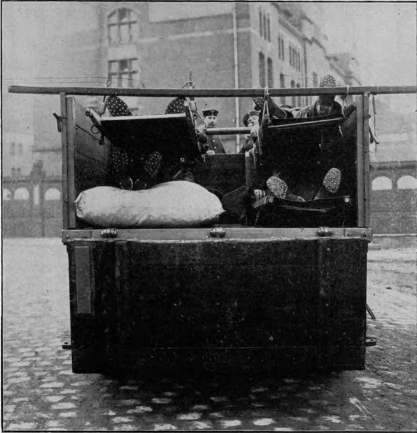
Bild 72. 3 t-Lastkraftwagen mit 8 Scheinverwundeten mit Lagerung der Verwundeten auf Strohsäcken, auf Krankentragen in einfachen Strickschlaufen und in Hunsdieckerschen Federn.
