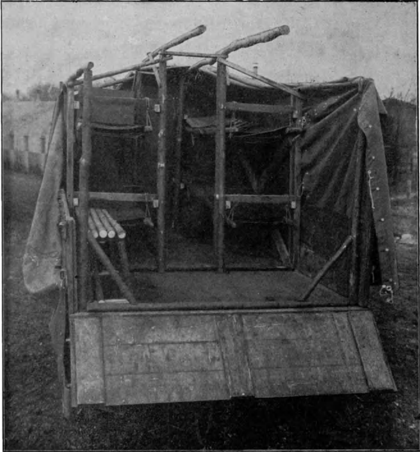
Bild 100. Behelfsmäßig hergerichteter Maschinenwagen des Armeelastzuges (Sanitätskolonne Steglitz).
