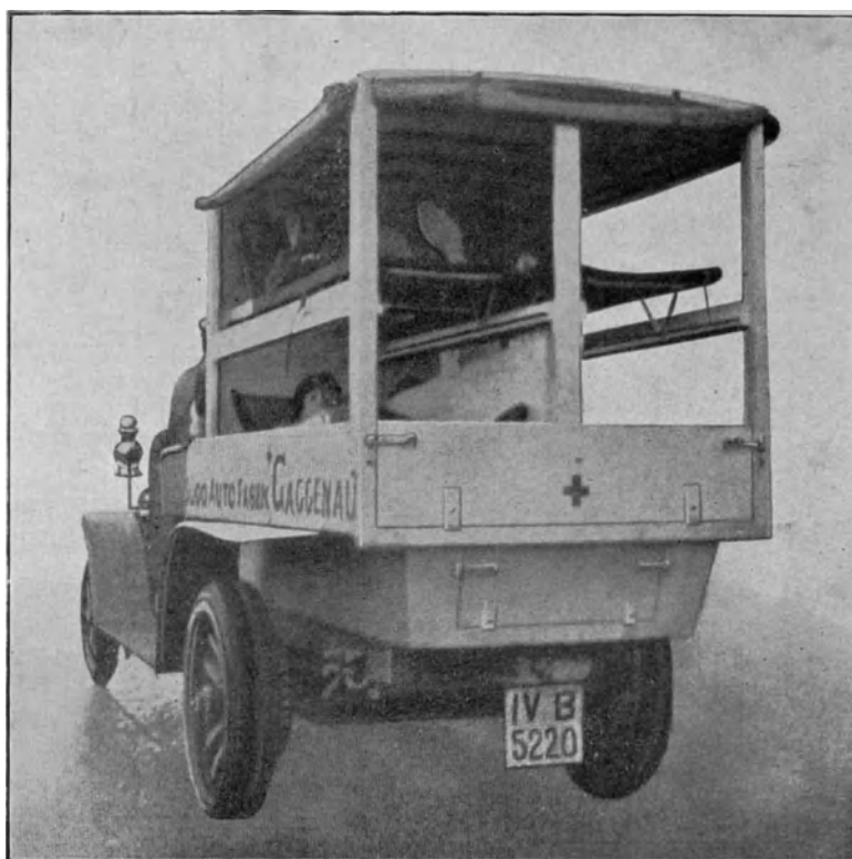
Bild 86. Leicht abnehmbarer Wagenaufsatzkasten zur Aufnahme von 4 Krankentragen (Badischer Landesverein vom Roten Kreuz).
