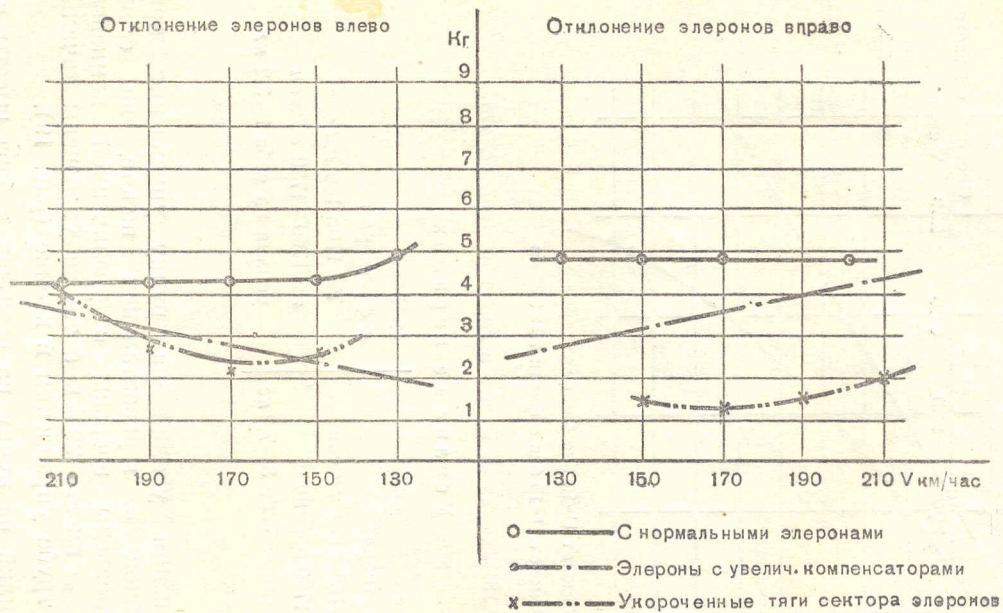
Рис. 19. Кривые усилий на ручку управления при отклонении элеронов в горизонтальном полете.
