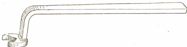
Рис. 29. Ключ для вертикальной регулировки верхнего правого пулемета.
