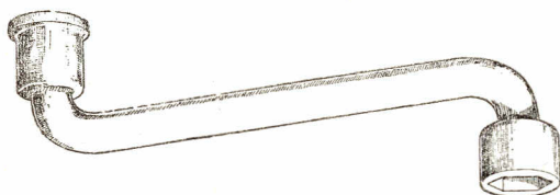
Рис. 30. Ключ для горизонтальной регулировки пулемета.
