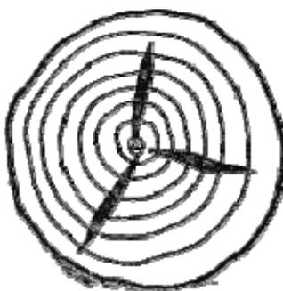
Рис. 26. Сердцевидные трещины.
