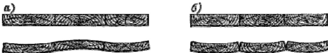
Рис. 126. Расположение досок при сплачивании. а) правильное; б) неправильное.
