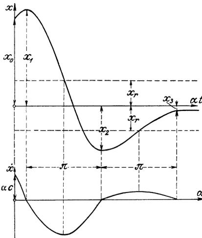
itten von  $+x_r$  auf  $-x_r$  entspricht und die in Abb. 100 gezeichnete Weg- und Laufkurve ergibt. Beide bestehen aus halben Sinuslinien, von denen diejenigen der Wegkurve sich an den Scheiteln tangential anschließen, während sie an den entsprechenden Punkten der Laufkurve Knicke bilden. Fällt die Hubumkehr wie  $x_3$  in Abb. 100 zwischen die Geraden  $\pm x_r$  der Schwingungsmitt
