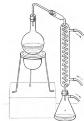
Abb. 18. Destillation mit Schlangenkühler.
