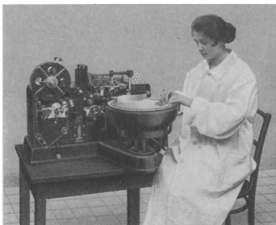
Abb. 319. Maschine zum Einhüllen von Zylindern, Briketts (Sublimatpastillen) (Berlin-Karlsruher Industrierwerke AG., Karlsruhe).
