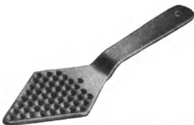
Abb. 313. Zählschaufel zum Abfüllen von Pillen und Tabletten (F. J. Stokes Machine Co., Philadelphia, USA.).
