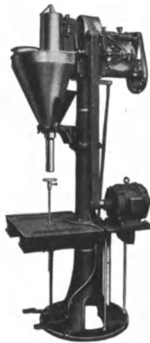
Abb. 299. Automatische Füll- und Dosiermaschine „Ideal II“ für pulverförmige und feinkörnige Produkte (Fritz Kilian, Berlin-Hohenschönhausen).
