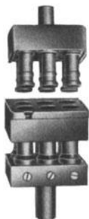
Abb. 88. Sechsstempliger Stempelsatz der Exzenter-Tablet- tenmaschine „Tietzco“ E 7 (Tietz & Co., Berlin).
