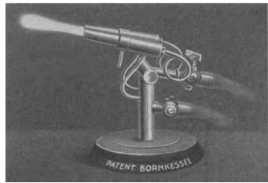
Abb. 248. Gasdoppelbrenner, dessen Flammen sich in einem Punkte vereinigen und nach der Vereinigung eine messerförmige Flammenschnede ergeben. Gd.: je 3 mm (Verein. Börnesselwerke m. b. H., Berlin N. 4).
