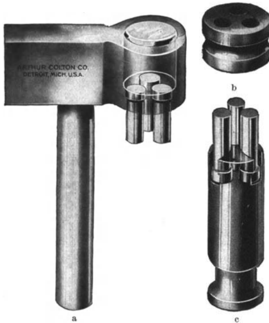
Abb. 78. Mehrfaches Stempelsystem der Coltonschen Rotationstablettenmaschine. a Oberstempel mit galgenförmigem Stempelschaft, b Matrize, c Unterstempel mit Schaft.
