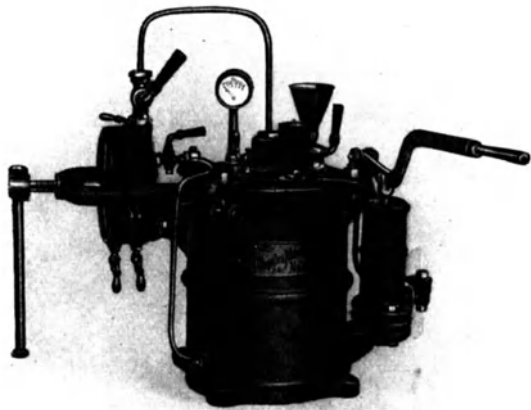
Abb. 111. Filterpresse für kleinere Flüssigkeitsmengen (Wegelin & Hübner AG., Halle a. S.).
