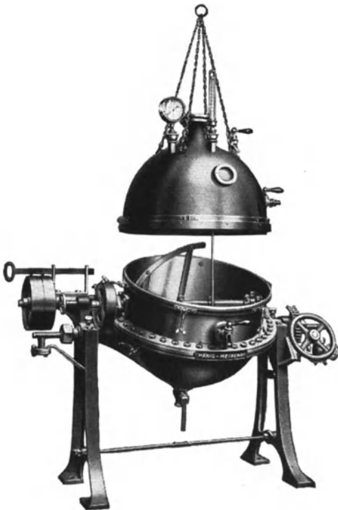
Abb. 134. Vakuumverdampfer mit horizontalem Rührwerk, hochziehbarer Haube und kippbarem Kessel (Volkmar Hänig & Co., Heidenau-Dresden).
