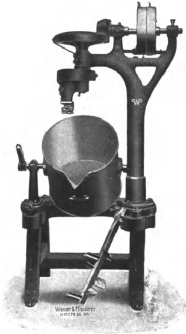
Abb. 169. Mischmaschine mit Planeten-Rührwerk. Rührflügel abgenommen, Rührkessel zur Entleerung gekippt (Werner & Pfleiderer, Cannstatt-Stuttgart).
