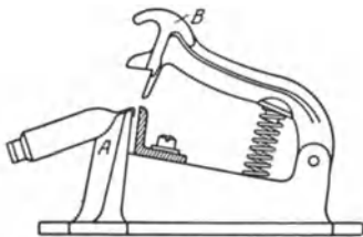
Abb. 181. Schema einer Tubenschließmaschine. Zweite Arbeitsphase.
