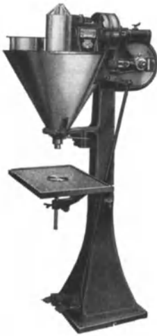
Abb. 298. Automatische Füll- und Dosiermaschine „Triumph“ für pulverförmige und feinkörnige Produkte (Fritz Kilian, Berlin-Hohenschönhausen).
