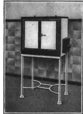
Abb. 271. Heißluftsterilisator für Temperaturen bis 200° C mit elektrischer Heizung (E. F. G. Küster G. m. b. H., Berlin N. 65).
