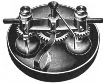
Abb. 176. Salbenreibmaschine für Quecksilbersalben. Reibschale von oben gesehen (Karl Seemann, Berlin-Borsigwalde).
