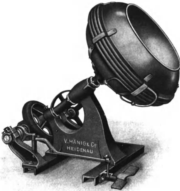
Abb. 231. Dragierkessel mit Dampfheizschlange.
