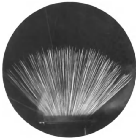
Abb. 23. Eine dichte Schar von Alphateilchen. Aufnahme von L. Meitner und K. Freitag. [Aus Z. Physik 37 (1926).]
