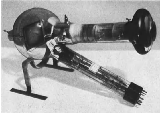
Abb. 385. Bildwandler-Elektronenstrahl-Bildzerleger der Forschungsanstalt der Reichspost [297].
