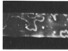
Abb. 420. Elektronenbilder eines thorierten Wolframdrahtes [440]. V 25:1.
