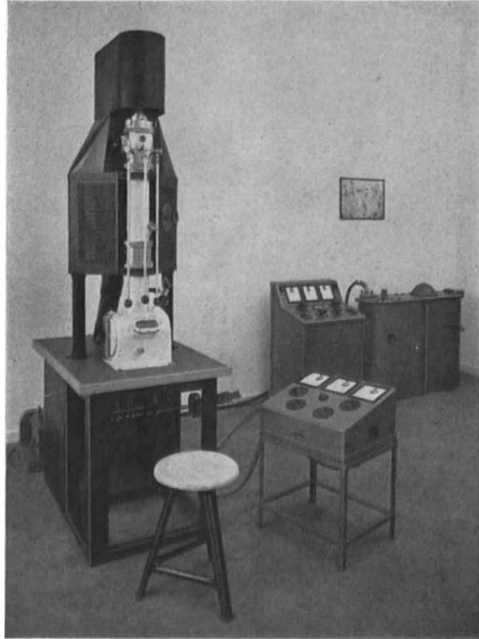
Abb. 455 b. AEG-Übermikroskop mit der gesamten Spannungsanlage.
