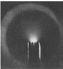
Abb. 422. Dunkelfeldabbildung eines Dampfstrahls [74]. V 12:1.
