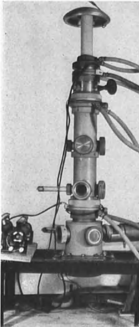
Abb. 429. Magnetisches Durchstrahlungsmikroskop für hohe Vergrößerungen [588].
