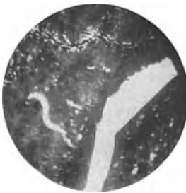
Abb. 421. Abbildung einer Goldfolie [73]. V 15:1. a Hell- und b Dunkelfeldbild.
