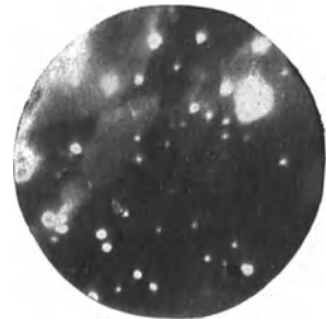
Abb. 402. Emissionsbild eines Wolframbandes [135]. V 25:1.
