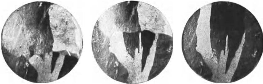
Abb. 426. Umkristallisation von Eisen beim Umwandlungspunkt [151]. V 30:1.
