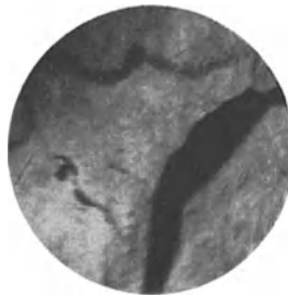
Abb. 421. Abbildung einer Goldfolie [73]. V 15:1. a Hell- und b Dunkelfeldbild.
