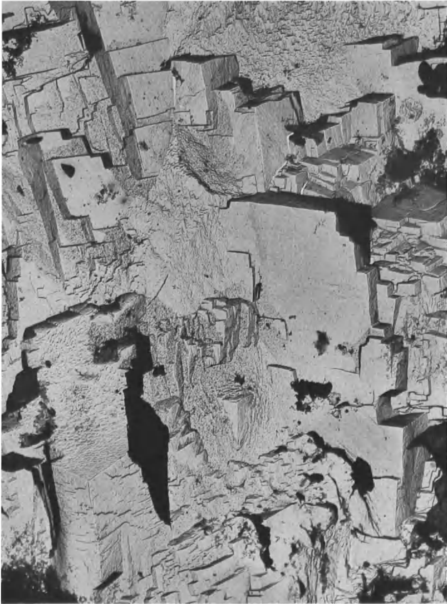
Bild VII. Übermikroskopisches Oberflächenbild von Aluminium mit Eisen verunreinigt, nach MAHL. Auf dem mit einem Gemisch von Fluß- und Salzsäure angeätzten Aluminium wurde elektrolytisch ein Oxydfilm erzeugt. Dieser Oberflächenfilm läßt sich ablösen. Er gibt ein Abbild der Oberfläche, deren kubischer Abbau nun im Durchstrahlungs-Übermikroskop untersuchbar wird. V 5000:1.
