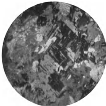
Abb. 427. Photoelektronenbild einer Nickelfolie [277]. V 20:1.
