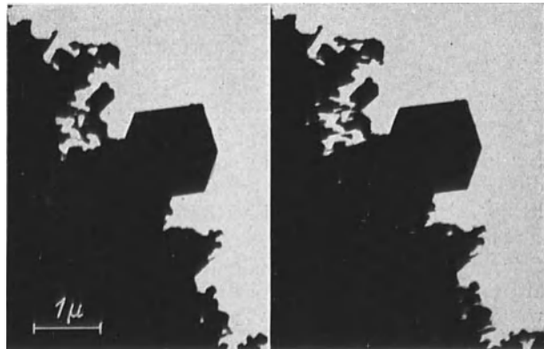
a b Abb. 83. Magnesiumoxyd-Rauch mit dem elektrischen Übermikroskop aufgenommen, a mit Gleichspannung, b mit Wechselspannungsspitze [446a].
