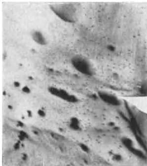
Abb. 441. Kolloidales Gold auf Gelatinefilm [48]. V 2900:1.
