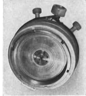
Abb. 116. Gepanzerte magnetische Linse kleiner Brennweite [588].
