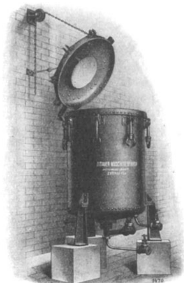
Abb. 23. Hochdruck-Kochkessel mit Deckelgelenk.
