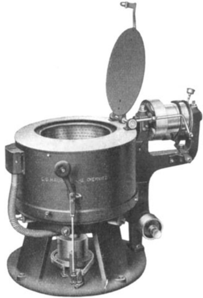
Abb. 31. Zentrifuge mit Unterantrieb durch ein am Zentrifugenmantel befestigtes Vorgelege und mit Sicherheitsdeckelverschluß (C. G. Haubold A. G., Chemnitz).
