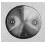
Bild 3. Lichtbild der Hohlkathode nach mehrstündigem Betrieb.
