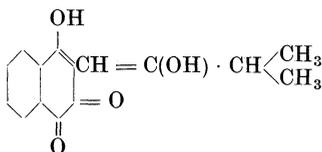
Entsteht beim 3stündigen Kochen von 6 g Isopropylfuran- $\alpha$ - oder  $\beta$ -Naphthochinon mit 600 ccm Natronlauge von 1%. Nach dem Erkalten leitet man Luft durch und fällt die fil-
