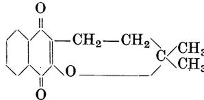
Entsteht beim Erhitzen (1 $\frac{1}{4}$  Stunde) von 2 g Lapachol in 20 ccm Eisessig mit 5 ccm Salzsäure (spez. Gew. 1,2). Hellgelbe Nadeln. Schmelzpt. 117°. Bildet mit Salzsäure ein Additionsprodukt, das aber schon durch Wasser zerlegt wird. Unlöslich in kalten Alkalien. Beim Kochen mit verdünnter Kalilauge entsteht Oxyhydrolapachol. Geht durch Auflösen in Vitriolöl in  $\beta$ -Lapachon über.
