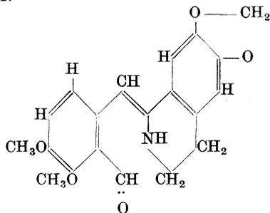
Entsteht beim Versetzen der braunroten Lösung der freien Berberinbase mit überschüssiger Natronlauge als hellgelb gefärbter Niederschlag. Hellgelbe Krystalle. Schmelzp.  $144^\circ$ . Löslich in Äther und Benzol, unlöslich in Wasser und wenig in Alkalien. Beim Erwärmen mit Wasser verwandelt es sich unter intensiver Gelbbraunfärbung in das Berberiniumoxyd. Hat die Eigenschaften eines Aldehydes. Mit 30proz. Natronlauge auf dem Wasserbade erwärmt, gibt es Dihydroberberin und etwas Oxyberberin.
