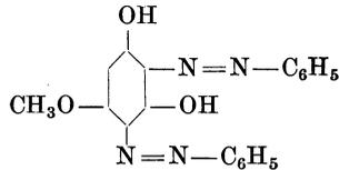
entsteht, wenn man die bei der Aufspaltung mittels Durchleiten eines Luftstromes durch eine alkalische Lösung des Rhamnazins sich bildenden Phenole mit Diazoniumsulfat bei Gegenwart von Natriumcarbonat kuppelt.
