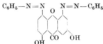
Entsteht, wenn eine schwach alkalische Lösung von Euxanthon mit einer Lösung von 2 Mol. Diazobenzolsulfat versetzt wird. Roter Niederschlag, krystallisiert aus einem Gemisch von Eisessig und Nitrobenzol in ziegelroten Nadeln. Schmelzp. 249—250°. Unlöslich in kalten, verdünnten Alkalien; beim Erwärmen löst es sich unter teilweiser Zersetzung. Besitzt keine färbenden Eigenschaften.
