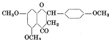
Dieses wird in Chloroformlösung mit 3 Mol.-Gew. Brom bromiert und das entstandene 2, 4- $\alpha$ -Tribrom-1, 3, 4'-trimethoxyflavanon (I) mit alkoholischem Kali behandelt.
