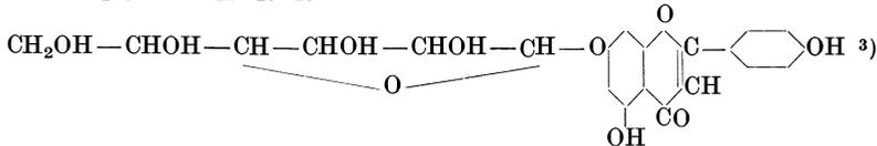
10 g Apiin werden in 1 l heißem Wasser gelöst, 70—80 ccm Normalschwefelsäure hinzugefügt, dann wird 1/2 Stunde gekocht. Der beim Erkalten nach 12stündigem Stehen sich bildende Niederschlag wird abfiltriert, getrocknet und aus verdünntem Alkohol umkrystallisiert. Weißgelbe, krystallinische Masse. Schmelzpt. gegen 215—220°. Unlöslich in Äther, Chloroform
