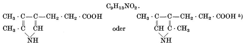
**Bildung:** Bei der Reduktion des in rauchender Salzsäure gelösten Hämatoporphyrins resp. Desoxyhämatoporphyrins mit Sn, neben Hämopyrrol und Hämatopyrrolidinsäure. Aus der letzteren bei ihrer Aufspaltung durch Verschmelzen mit KOH<sup>6)</sup>.
