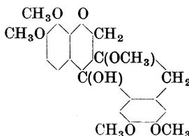
Darstellung siehe Tetramethylhämatein; es bleibt in dem Auszug mit siedendem Petroläther oder Essigester gelöst und wird später aus Alkohol umkrystallisiert. Gelbliche, vierseitige Tafeln (aus Alkohol). Schmelzp. 159—160°. Leicht löslich in siedendem Alkohol, Essigester, Chloroform; schwer löslich in Petroläther.
