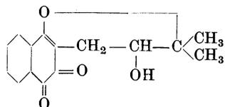
Entsteht, wenn man Lomatiol in wenig konz. Schwefelsäure löst und die schwefelsaure Lösung längere Zeit stehen läßt. Dadurch nimmt das Dihydrolapachon 1 Mol. Wasser auf und geht in das Oxy- $\beta$ -Lapachon über. Rote Nadeln. Schmelzp. 204°. Unlöslich in kalten verdünnten Alkalien.
