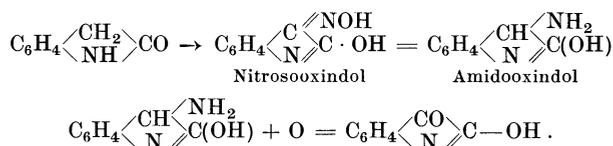
Bei der Oxydation von Indigo durch Salpeter- oder Chromsäure<sup>5)</sup>. Aus o-Amidophenylglyoxylsäure<sup>6)</sup>. Durch Oxydation<sup>7)</sup> von Indoxyl, Indoxylsäure usw. in saurer, neutraler oder alkalischer Lösung. Aus Isatin- $\alpha$ -anilid<sup>8)</sup> durch Erhitzen mit verdünnten Mineralsäuren. Durch Erhitzen<sup>9)</sup> eines Gemenges von Phenylglycin und Alkalien über 200° unter mäßigem Zutritt von Luft.
