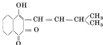
Entsteht, wenn man zu der Lösung von 10 g 2-Oxynaphthochinon (1,4) in 175 ccm warmem Eisessig 35 ccm Isovaleraldehyd und 50 ccm Salzsäure fügt, das Gemisch 20 Minuten auf dem Wasserbade erhitzt und darauf in Wasser gießt. Ziegelrote Nadeln (aus Alkohol). Schmelzp. 120°. Sehr leicht löslich in Alkohol, Äther, Benzol usw. Löslich in Kalilauge mit intensiver Purpurfarbe. Absorbiert in Chloroformlösung Brom; beim Stehen des Bromides mit Alkohol entsteht Isopropylfuran- $\beta$ -Naphthochinon.
