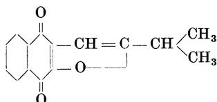
Entsteht bei  $\frac{1}{4}$ stündigem Kochen von 8 g Dioxyhydrolapachol mit verdünnter Schwefelsäure (200 ccm Vitriolöl + 400 ccm Wasser); das beim Stehen auskrystallisierende Produkt wird 1 Tag mit Natronlauge von 1% digeriert. Beim Kochen von Oxy- $\alpha$ -Lapachon mit Schwefelsäure (1 Vol. Schwefelsäure und 2 Vol. Wasser). Kanariengelbe Nadeln aus Alkohol. Schmelzp. 110°. Lösung in Vitriolöl intensiv karmoisinrot. Geht durch Kochen mit verdünnter Natronlauge in Oxyisolapachol über.
