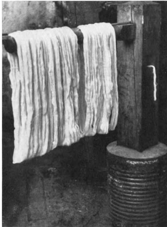
Abb. 52. Transportabler „Teilstock“, in eine Farbstofftrommel einzementiert.
