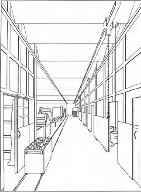
Abb. 6. Blick in den Fabrikraum einer großen Veredlungsanstalt. Die hellgestrichenen Glaswände teilen einzelne Abteilungen ab. Elektrohängezug und Transportloren sorgen für die Flüssigkeit der Fabrikation. Türen sind zum Schieben eingerichtet. Nicht alle Räume sind hinter Glaswänden anzubringen.
