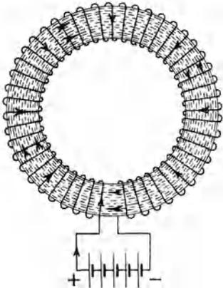
Abb. 42. Ringspule mit kreisförmig laufendem Kraftfluß.
