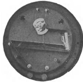
Abb. 79. Hitzdrahtinstrument mit abgenommenem Gehäuse.
