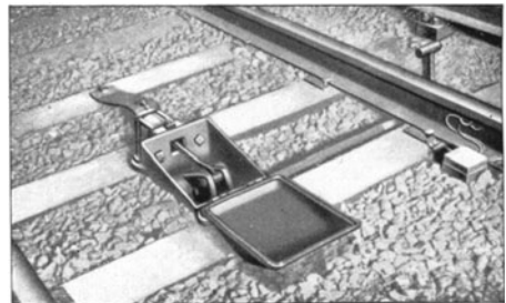
Abb. 49. Fahrsperre mit Druckluftantrieb.
