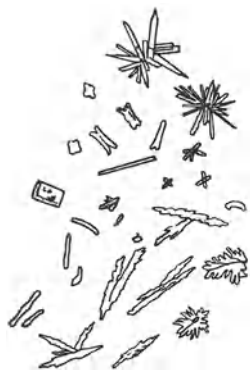
Abb. 3. \text{Li}_2\text{CO}_3 , mit Ammoniumcarbonat gefällt (nach HUYSSÉ).
