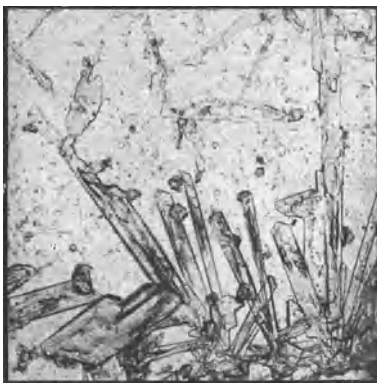
Abb. 13. Natriumhexachloroplatinat, wie es gewöhnlich beim Eintrocknen am Tropfenrande auskristallisiert (nach GEILMANN). Vergr. 65fach.
