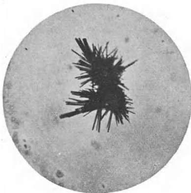
Abb. 9. Reaktionsprodukt von 2,4,5-Trinitro-1-naphthol (Naphtholpikrinsäure) mit Ammoniak.
