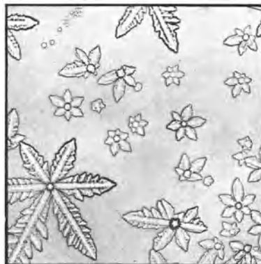
Abb. 9. Sechsbältrige Rosetten von \text{Na}_2\text{SiF}_6 (nach GEILMANN). Vergr. 80fach.
