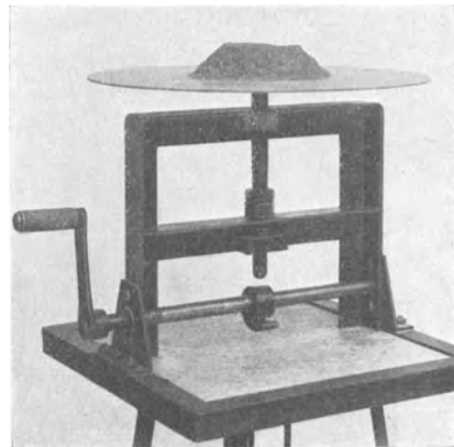
Abb. 16. Fließtisch zur Bestimmung der Plastizität des Betons.
