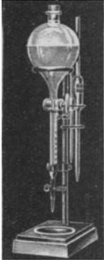
Abb. 13. Apparat Säuregradsbestimmung nach HENKEL
