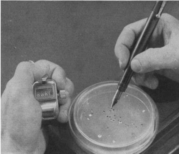
Abb. 13. Zählen von Kolonien nach der Plattenmethode mittels eines automatischen Zählapparates
