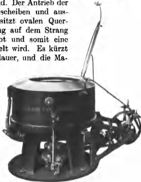
Abb. 7. Zentrifuge mit Unterbetrieb durch Vorgelege und Riemen.
