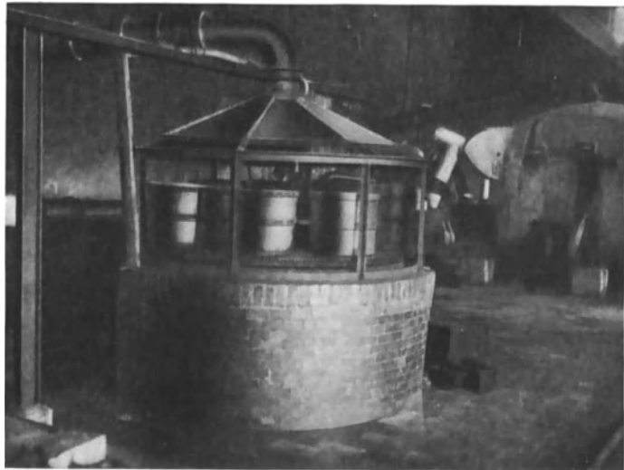
Abb. 9. Nitriertöpfe auf Drehscheibe.
