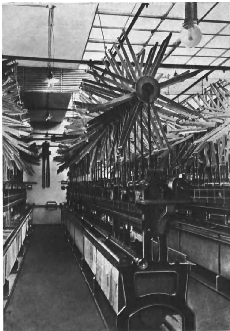
Abb. 34. Roßhaarspinnapparat mit Haspelkronen von der Seite.
