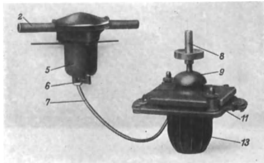
Abb. 34. Spinntopfmotor der Siemens-Schuckertwerke G. m. b. H. 2 Hauptleitung, 5 Schaltergehäuse, 6 Schalthebel, 7 Motorzuleitung, 8 Aufsatzstück für den Spinntopf, 9 Schutzhaube, 11 Gummipuffer, 13 Motorgehäuse.
