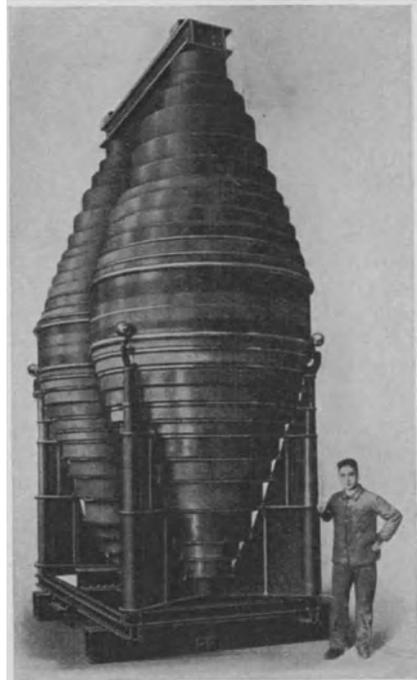
Abb. 71. Gewickelte Hartpapier-Rohre für einen Prüftransformator von 600 000 V und 300 kVA.
