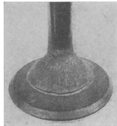
Abb. 147. Riß in der Hohlkehle eines Tulpenventiles infolge Wärmestaus.
