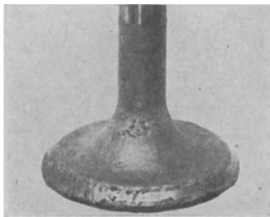
Abb. 144a. Grübchenbildung am Ventilsitz und in der Hohlkehle.
