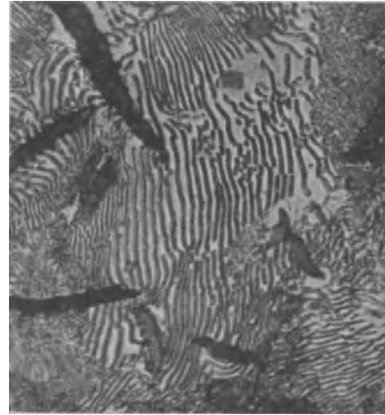
Abb. 73. Geätzt 2%ige alkohol. HNO_3 — 500 ×. Gutes Gefüge: mittelfeiner bis groblamellarer Perlit. Abb. 69—74. Gefügeausbildung in Sandguß-Zylinderlaufbüchsen.
