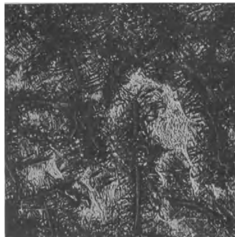
Abb. 109. Martensitisches Gefüge einer vergüteten Schleudergußbuchse. H_B = 415 .
