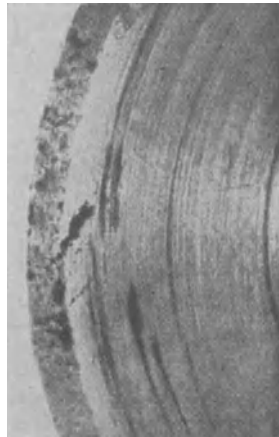
Abb. 144a. Grübchenbildung am Ventilsitz und in der Hohlkehle.
