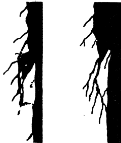
Abb. 183. Grübchenbildung an Zahnradern. Ausgangsstellen sind die feinverästelten Anrisse (nach AENGENYNDT).
