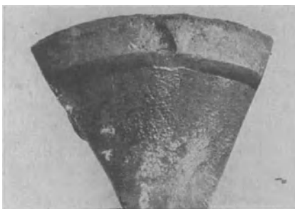
Abb. 145. Ausbrennungen am Ventilsitz.
