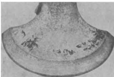
Abb. 151. Korrosionserscheinungen an der Tellerunterseite infolge unrichtigen Faserverlaufs im Teller.
