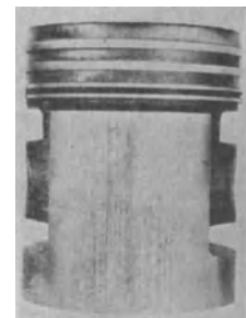
Abb. 129. Freßzerstörungen der Kolbengleitfläche bei Kraftstoffüberschwemmung und Kaltstart (pockenartige Freßstellen)
