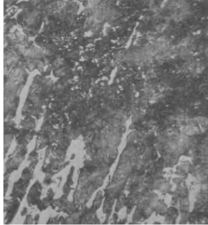
Abb. 80. Geätzt 2%ige alkohol. \text{HNO}_3 — 500 ×. Fehlerhaftes Gefüge; Perlit und Sorbit mit viel strah- ligem Zementit; kleine Ferritnester in eutektischen Graphitrossetten.
