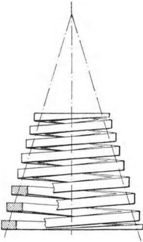
Abb. 16. Kegelstumpf-feder mit konstantem Steigungswinkel. Rechteckiger Draht.
