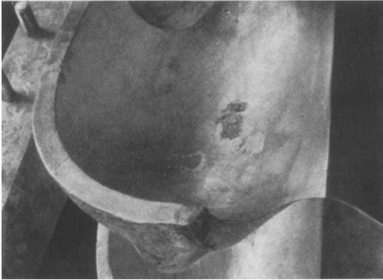
Abb. 8. Erosion durch Tropfenschlag an einem Peltonturbinenbecher.
