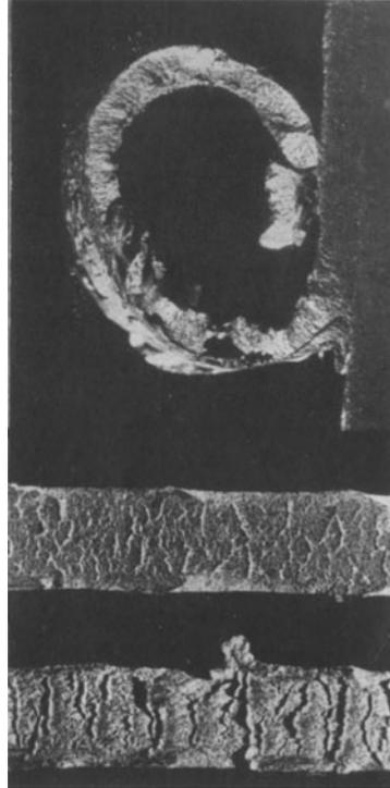
Abb. 23. Zunahme der Einrisse (Schluchten) mit abnehmender Schnittgeschwindigkeit.
