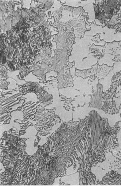
Abb. 99. Ferritkristalle in Perlit. Stahl mit 0,45% C langsam abgekühlt. V 600 $\times$ .
