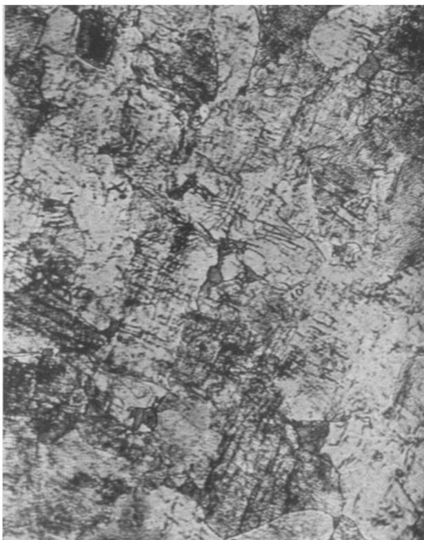
Abb. 20. Korrosion durch Ätzmittel in den Rutschebenen eines kaltverformten weichen Eisens. V 400×.
