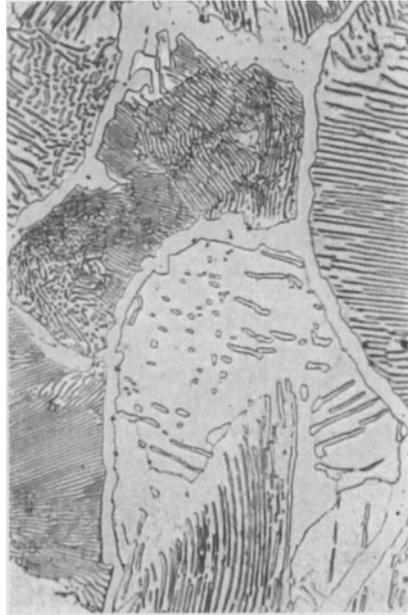
Abb. 100. Sekundärer Zementit (Korngrenzenzementit) in Perlit. V 1200 $\times$ .
