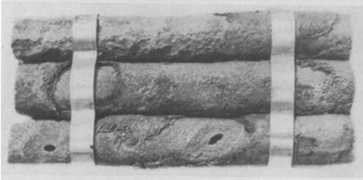
Abb. 1. Korrosion an Rohrleitungen durch Streuströme.
