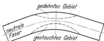
Abb. 7. Darstellung der gestauchten und gedehnten Zonen einer Biegeprobe.
