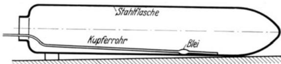
Abb. 2. Berührungskorrosion in einer Stahlflasche: Schematische Skizze.
