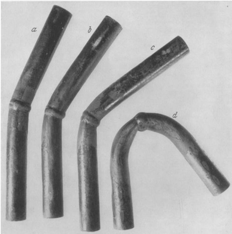
Abb. 56. Biegeproben von geschweißten Rohren. a bis c schlecht (Rißbildung auf der Zugseite), d gut.
