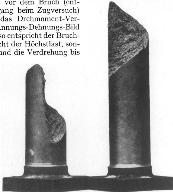
Abb. 93. Verdrehbruchfläche eines spröden Werkstoffes (Gußeisen) (SCHULZE-VOLLHARDT).
