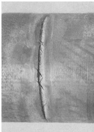
Abb. 19. Korrosionsermüdungsrisse in einer Schiffswelle, stark verkleinert.
