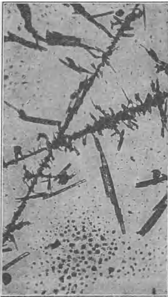
Fig. 107. Überzug von Kristallen der Alkalicarbonate.
