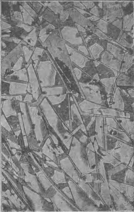
Fig. 110. Oberfläche durch Eintrocknen aufgesplittert. Newtonsche Farbenringe.
