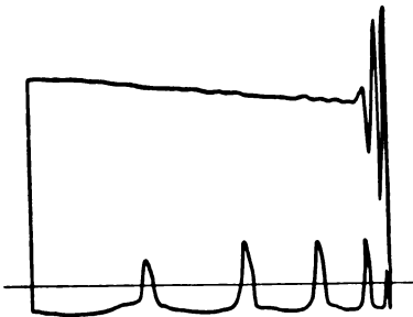
Abb. 22. Diagramm bei gesteuerten Klappen. (46 Uml./min, 4 mm = 1 at, p_i = 6,44 .)
