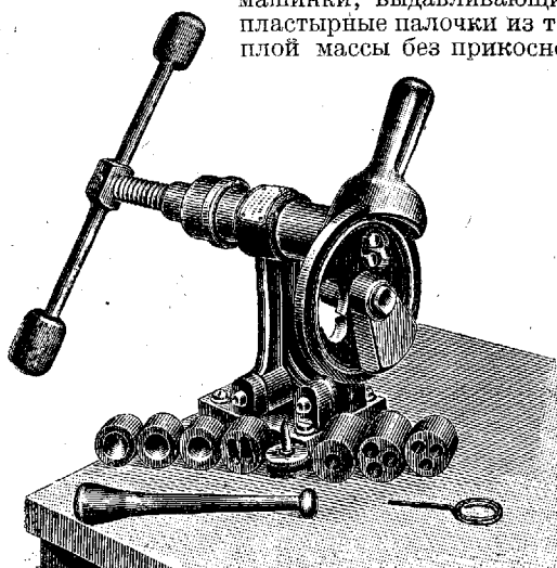
Рис. 2. Универсальный пресс со втулками для изготовления пластырных стержней.
