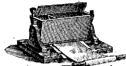
Рис. 1. Машина для намазывания пластырей, обогреваемая водой.
