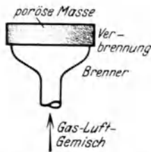
Abb. 38. Schema eines Brenners für Oberflächenverbrennung.
