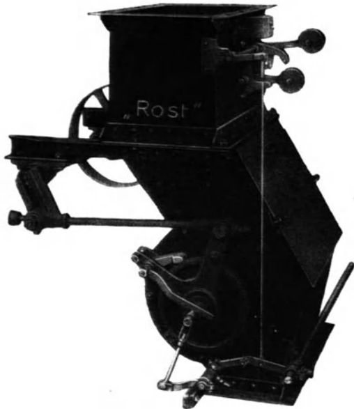
Abb. 209. Zuteiler mit Zellenwalze, mit Kontakt und selbsttätiger Abstellung bei eintretendem Materialmangel (E. Rost, Maschinenbauanstalt, Mainz).
