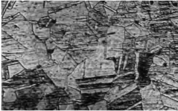
Abb. 43. Austenitgefüge von nichtrostendem V2A-Stahl. Vergr. 200 fach.
