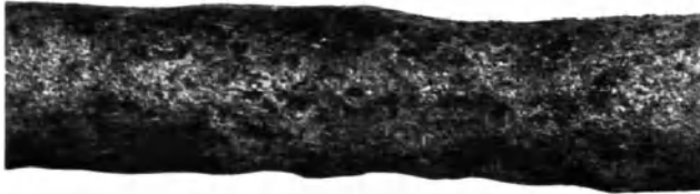
Abb. 9. Gleichmäßige Korrosion eines Stahlrohres durch Bodenwässer.
