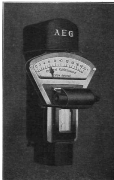
Abb. 80. Ranarex-Gasdichteschreiber als Rauchgasprüfer mit eingeschalteter Beleuchtungsvorrichtung.
