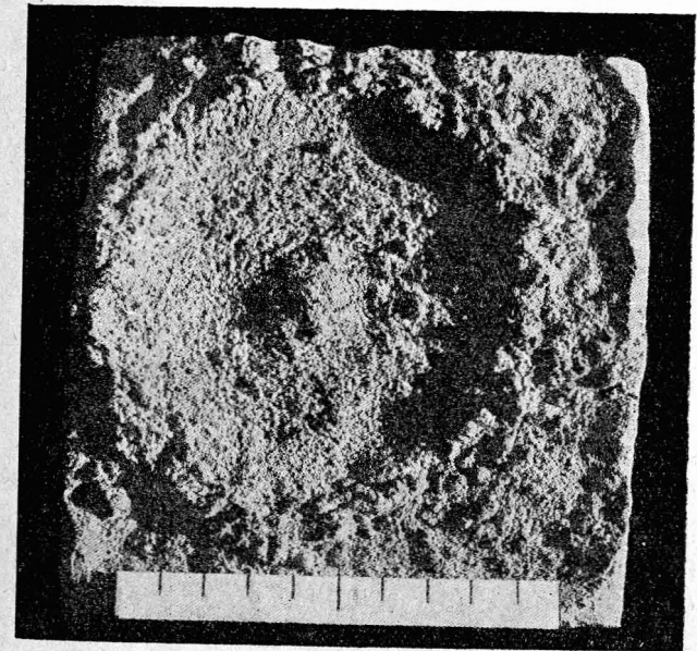
Рис. 3 и 4. Кратеры падения из цементного порошка. (Деления соответствуют сантиметрам).
