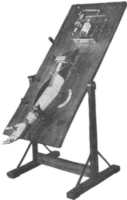
Abb. 84. Aufspannvorrichtung für Kunstarme, die gestattet, den Kunstarm mit Hand in allen Lagen im Raume zu prüfen.
