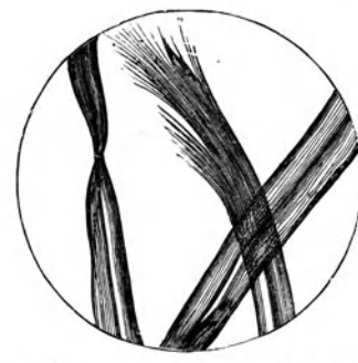
Mikroskopisches Aussehen der Tussurseeide
