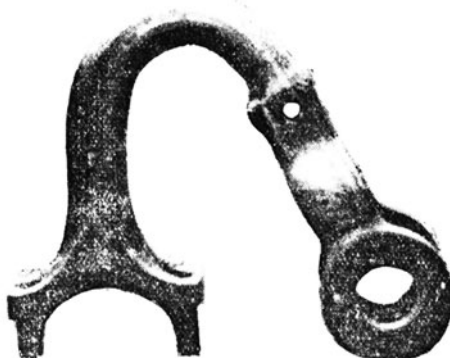
Eine beim Anlassen gebogene Pleuelstange einer Kreuzkopfmaschine.
